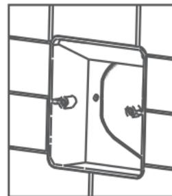
б) После подключения проводов, зафиксируйте терморегулятор на прикрепленную металлическую рамку - панель.
